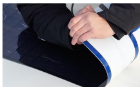
Aurinkopaneelit liimataan ajoneuvon katon kaksipuoliseen teippiin (valmiina paneelissa).
